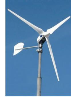
Modèle le plus répandu, l'éolienne horizontale est également la plus rentable. Son très bon rendement est permis par son mât de très grande hauteur, permettant aux hélices de capter un vent plus puissant. Inconvénients : Elle est assez bruyante, Elle nécessite un terrain dégagé Elle fonctionne avec un vent d'une vitesse comprise entre 15 et 80km/h
